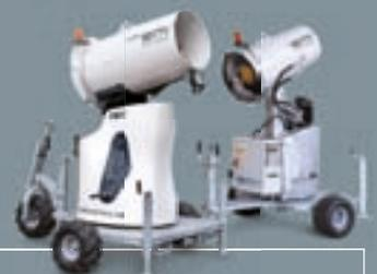
Spezialdüsen mit Keramikeinsatz erzeugen feinsten Sprühnebel, der die Staubpartikel an der Quelle bindet. 52° Neigungswinkel und 360° Schwenkwinkel machen die V12 und die V7 zu einem universellen Staubbinder mit hohem Aktionsradius.
